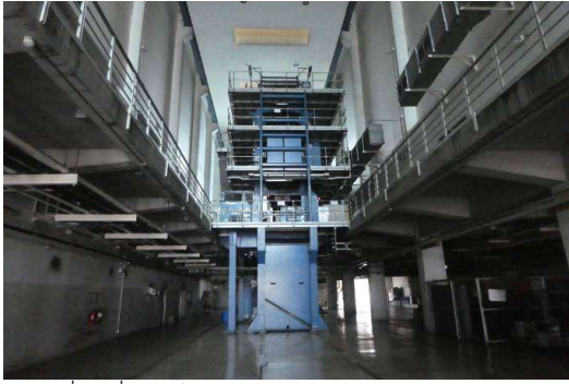
รายการที่ 1 เครื่องพิมพ์ (Newspaper Press Printing Machine)
